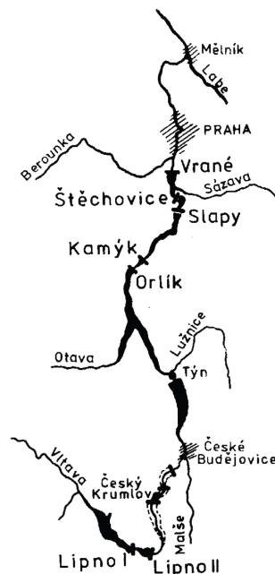
Obr. 1.11: Schéma Vltavské kaskády vodních elektráren [2]
