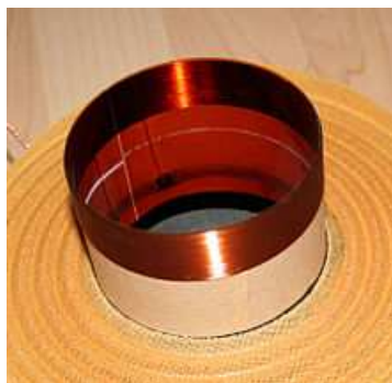
obr.8 Kmitací cívka a středící membrána elektrodynamického reproduktoru
