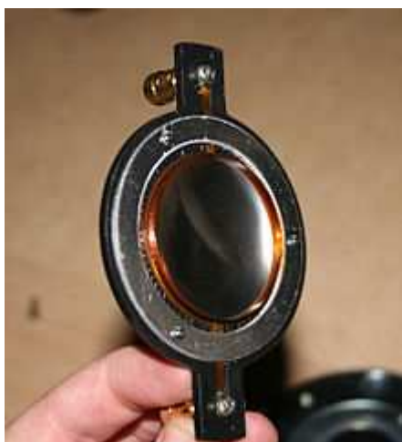
obr.9 Membránový systém vysokotónového reproduktoru, pohled zespodu na kmitací cívku
