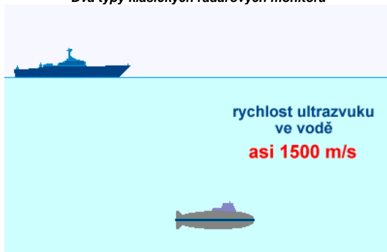
Princip ultrazvukového sonaru - vyhledávání objektů pod vodou
