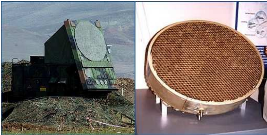
Pasivní anténní soustava protiletadlového raketového systému PATRIOT (vlevo) a aktivní fázovaná anténa palubního radaru letadla Gripen (vpravo)
