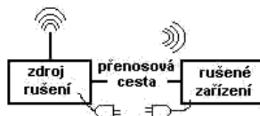
obr.3: Elektromagnetická kompatibilita závisí na vlastnostech zdroje, přenosové cesty a rušeného zařízení.
