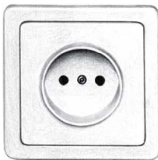
Zásuvka typu C podle normy CEE 7/16; je možno ji použít se zástrčkami typu C, E a F, nebude však fungovat zemnění!
