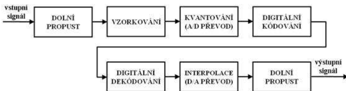
Obr. 30 Konverze analogového signálu na digitální a zpětná konverze
