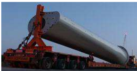
Kořenová část listu (tělo listu bez spoileru) při přepravě. Za povšimnutí stojí otvory na čele listu pro přišroubování koncové poloviny listu. Na povrchu rotorového listu jsou pak vidět otvory pro přišroubování spoileru.
