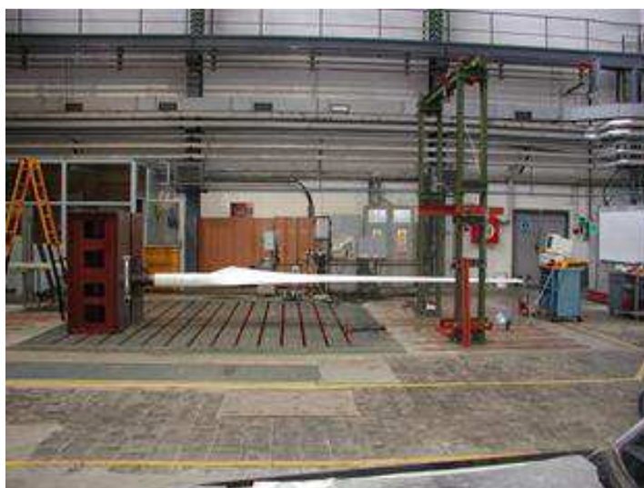
Rotorový list je umístěn vodorovně a na jeho konci je umístěn budič kmitů.
