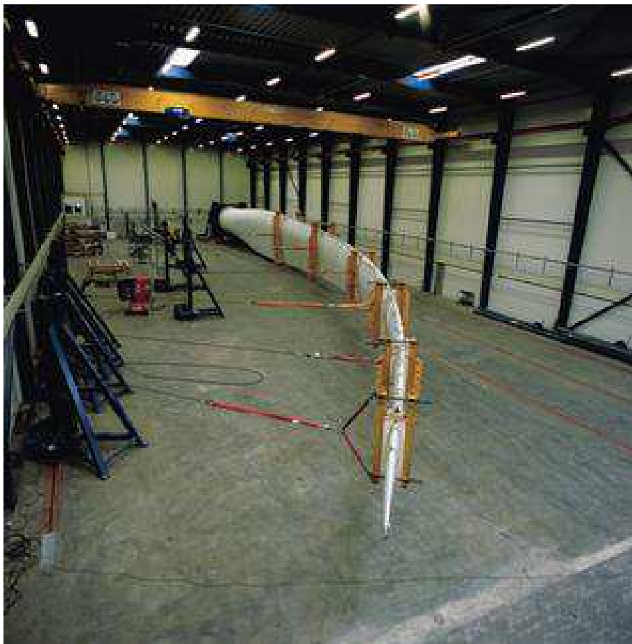
U rotorových listů velkých větrných elektráren, kdy jejich délka bývá i několik desítek metrů, bývá zatížení provedeno odlišným způsobem
