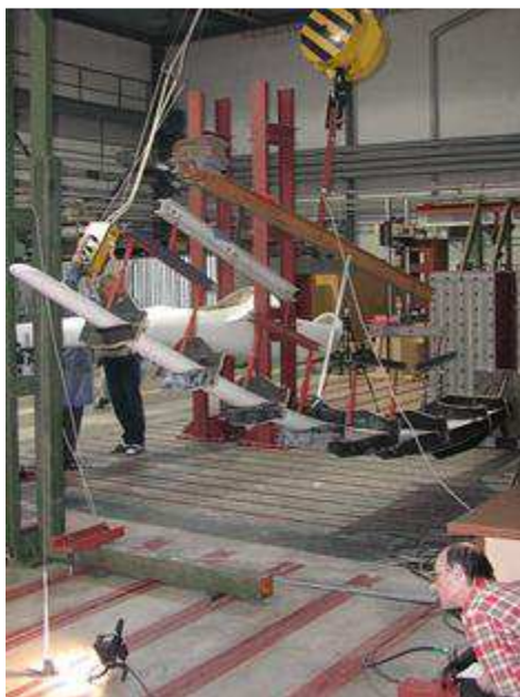
Průhyb listu při zatížení 130% provozního zatížení
