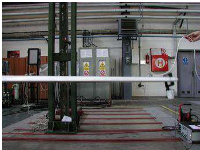
Kmitající list. Konec listu kmitá s výchylkou +/-20mm.
