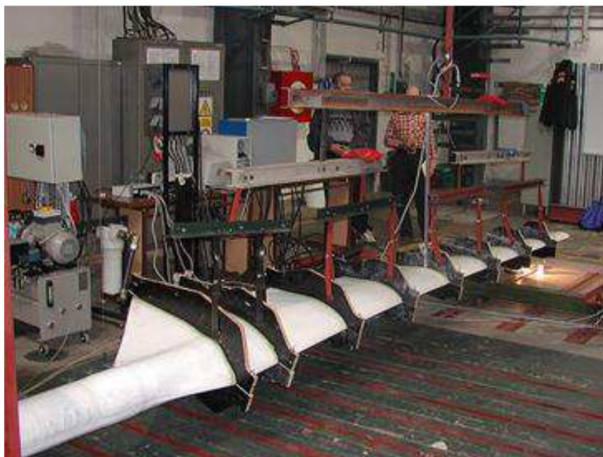
Rotorový list ve vodorovné poloze s umístěnými kleštinami, přes které je vyvozováno zatížení.
