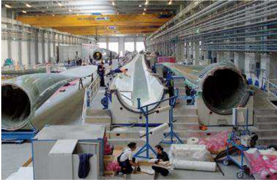
Pohled do haly laminování rotorových listů. Uprostřed je vidět forma s vylaminovanou polovinou listu. Po stranách pak již slepené listy ze dvou polovin.
