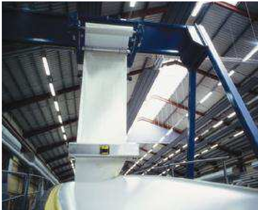
Při dané velikosti rotorových listů se některé vrstvy tkanin kladou strojově jako v tomto případě skelná tkanina.
