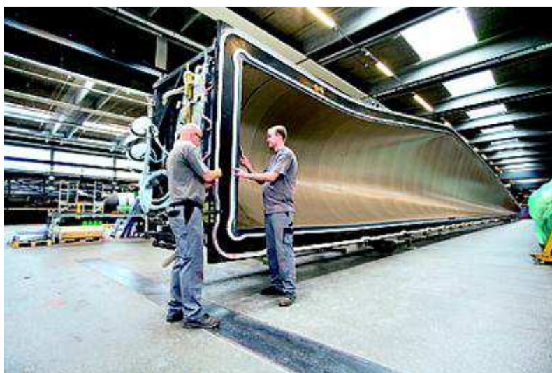
Negativní forma pro laminování rotorového listu. Na fotografii je vidět včetně nosného rámu a technologií pro vakuování
