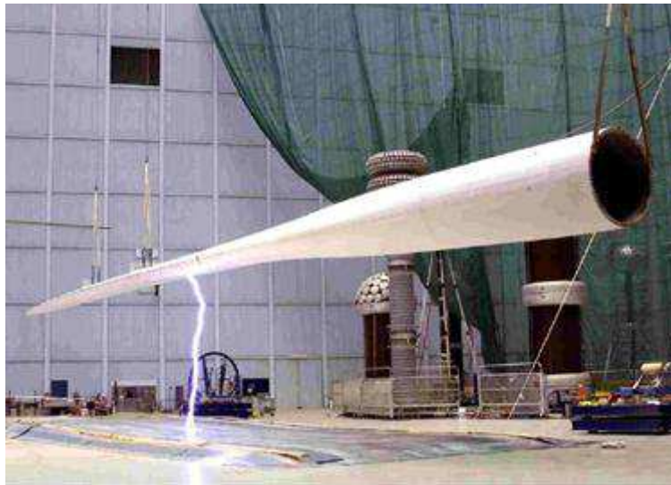
Výboj – 1484kV v čase 137μs (zkušebna LM Glasfiber)
