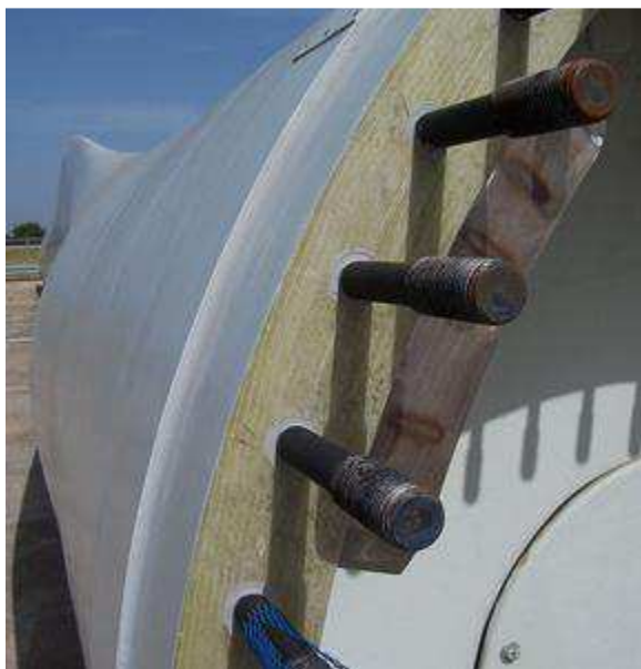
Pevnostní šrouby jsou zalaminovány přímo do stěny rotorového listu.
