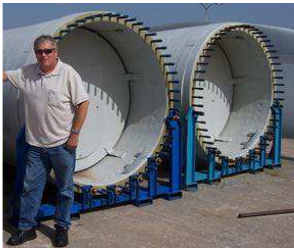
54 ks pevnostních šroubů sloužících k uchycení listu k rotorové hlavě.
