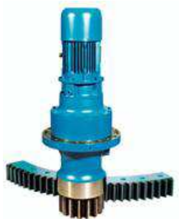
Elektropohon natáčení strojovny větrné elektrárny. Elektropohon je přišroubován k rámu strojovny, pastorek zabírá do vnější klece otočového ložiska. Tyto pohony bývají na instalovány v počtu 2, 4 či 6.
