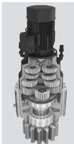
Elektropohon natáčení strojovny větrné elektrárny. Jedná se o elektromotor o výkonu 2kW, čtyřstupňovou planetovou převodovku, výstupní hřídel uložený ve válečkovém ložisku a pastorek.
