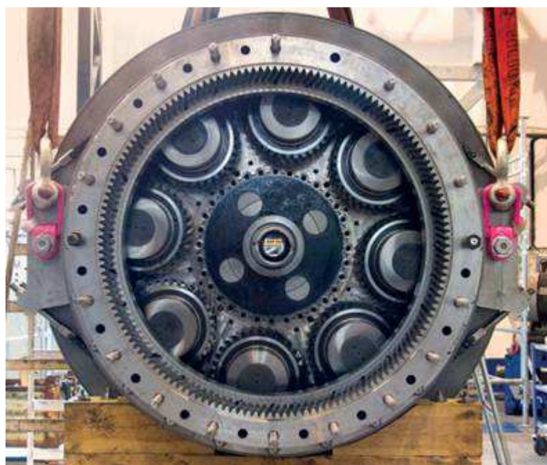
Detail převodovky Wikov. Planetový stupeň s osmi satelity uloženými na pružných čepech.
