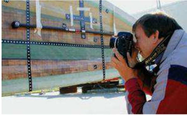
Umístění referenčních bodů na plochu listu rotoru
