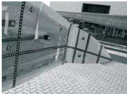
Vyfoceny rotorový list s terčíky připravenými pro 3D transformaci
