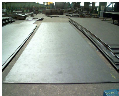
Vypálený polotovár připravený na skružení jednoho prstence Okraje vypálených plechů Detail technologických úkosů na okraji plechu
