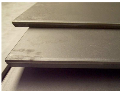
Vypálený polotovár připravený na skružení jednoho prstence Okraje vypálených plechů Detail technologických úkosů na okraji plechu
