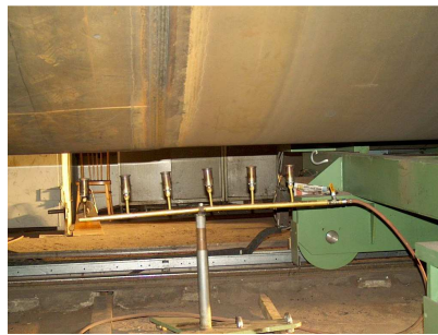
Plynové hořáky kontinuálně předehřívají oblast svaru
