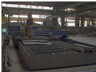
Vypalovačka pro rozměrné polotovary Kyslíko - acetylenové hořáky Detail trojice hořáků.
