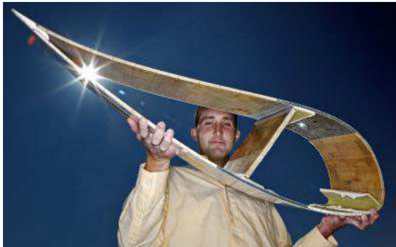
Řez rotorovým listem větrné elektrárny. Mezi vrstvy skelné tkaniny je vložena tvrzená pěna.
