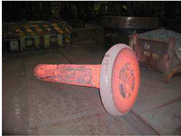
Budoucí hlavní hřídel větrné elektrárny. Zde ještě jako polotovar – výkovek.
