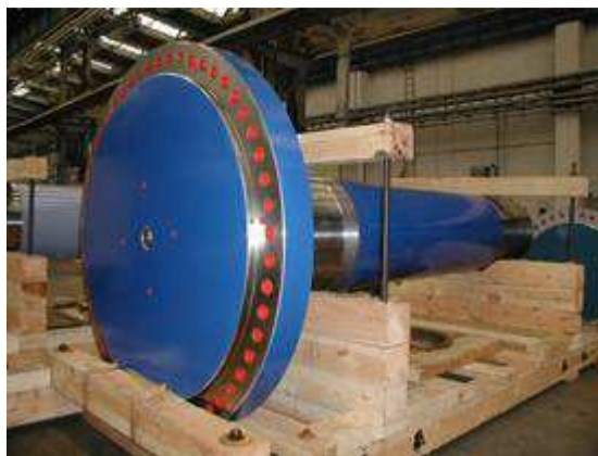
Hřídel větrné elektrárny připravená k exportu. V popředí obrázku je vidět příruba, na kterou bude usazena rotorová hlava. Červené krytky chrání závity, kde budou umístěny šrouby spojující hřídel a rotorovou hlavu.
