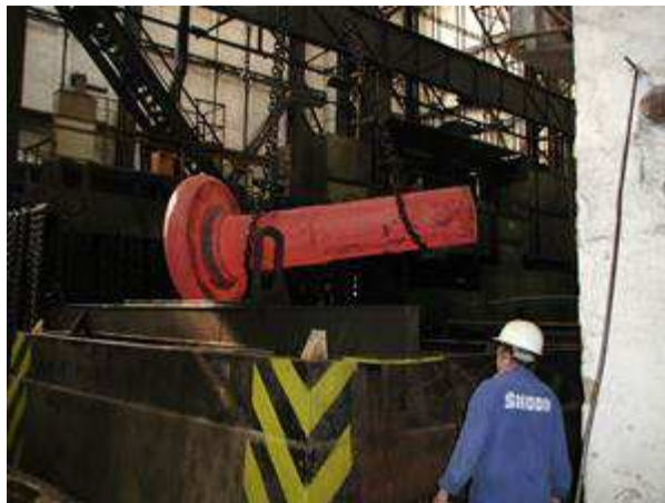
Manipulace s výkovkem hřídele pro větrnou elektrárnu
