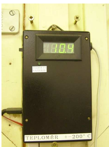
„Okenní teploměr“ typu „samovýroba“ s průmyslovým Pt čidlem
