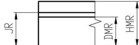
JMENOVITÝ ROZMĚR „JR“ JE ROZMĚR, K NĚMUŽ SE VSTAHLÍ OBA MEZNÍ ROZMĚRY. NA VÝKRESU JE PŘEDEPSÁN KÓTOU.
