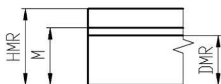
SKUTEČNÝ ROZMĚR JE ROZMĚR „M“, NAMĚŘENÝ S DOVOLENOU NEPŘESNOSTÍ NA HOTOVÉ SOUČÁSTI. MEZNÍ ROZMĚRY JSOU DVĚ KRAJNÍ DOVOLENÉ VELIKOSTI TĚHOŽ ROZMĚRU, MEZI NIMIŽ MUSÍ BÝT SKUTEČNÝ ROZMĚR ZJIŠTĚNÝ MĚŘENÍM. HORNÍ MEZNÍ ROZMĚR „HMR“ JE VĚTŠÍ Z OBOU MEZNÍCH ROZMĚRŮ. DOLNÍ MEZNÍ ROZMĚR „DMR“ JE MENŠÍ Z OBOU MEZNÍCH ROZMĚRŮ.
