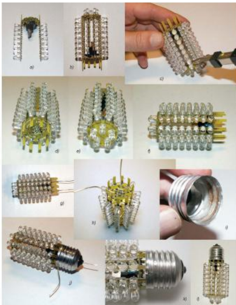
Obr. 4. Postup montáže LED žárovky
