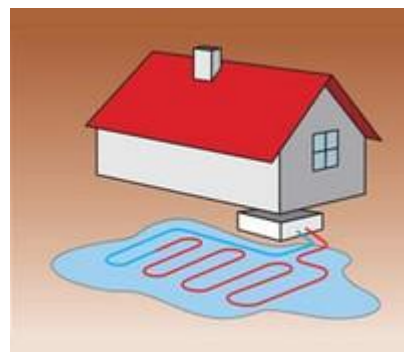
Tepelné čerpadlo nemrznoucí kapalina/voda - výměník naplněný nemrznoucí směsí ochlazuje půdu ve vrtu nebo ve výkopu, případně vodu ve vodním toku nebo v rybníku
