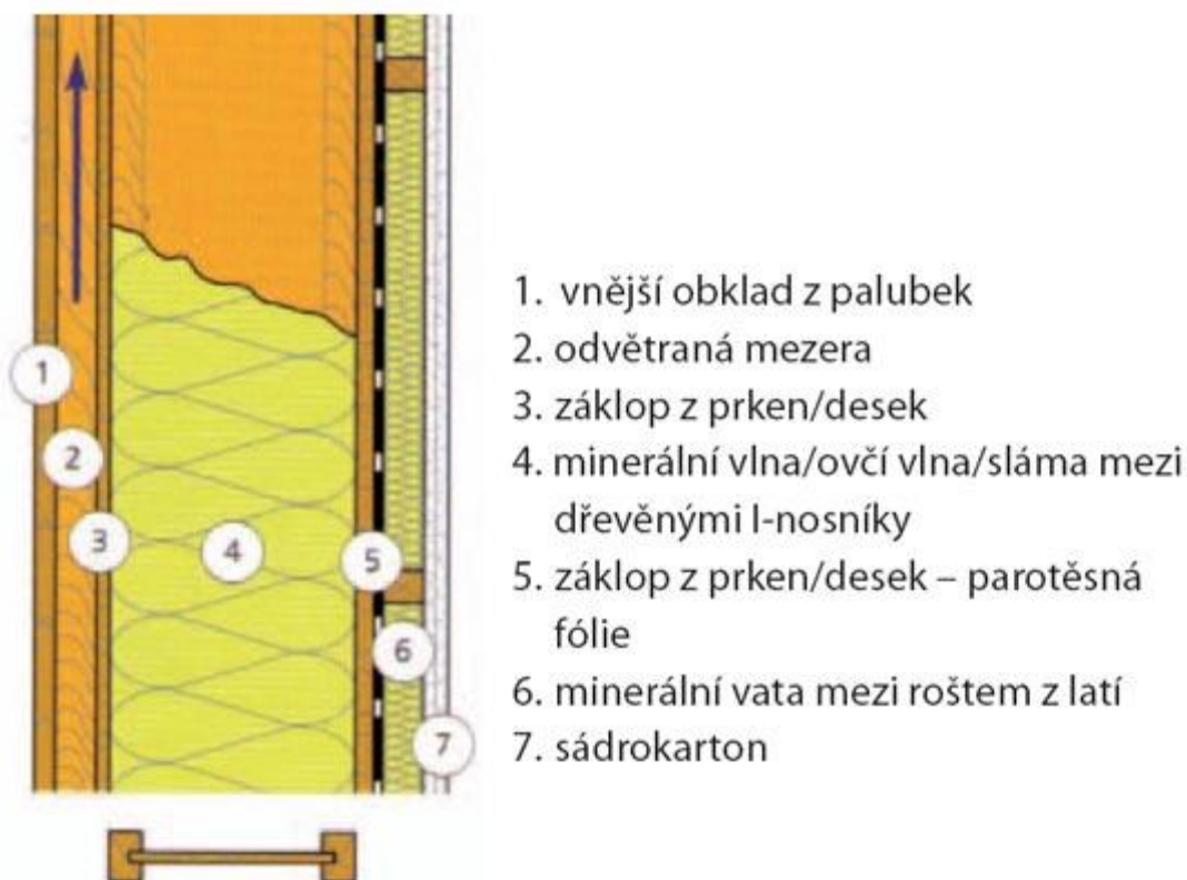
Schéma stěny s dřevěnými I-nosíky
