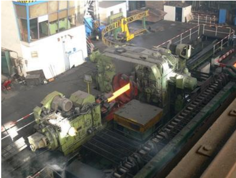
Rychlokovací horizontální stroj v kovárně Poldi Hütte, Kladno. Foto J. Hodan, 2007.
