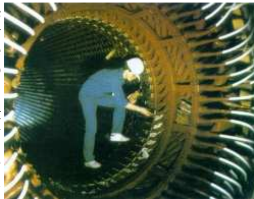
Stator turboalternátoru při montáži.
