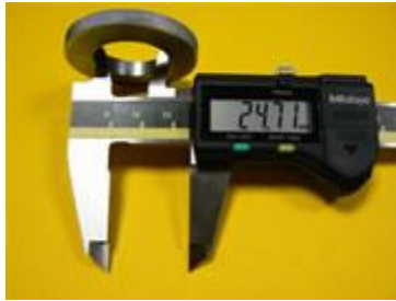
Měření vnitřních rozměrů
