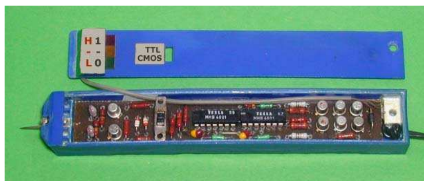
Obr. 4. Logická sonda se sundaným krytem - starší verze desky s plošnými spoji (V60) Figure 4. Logic Probe without cover (older version PCB)
