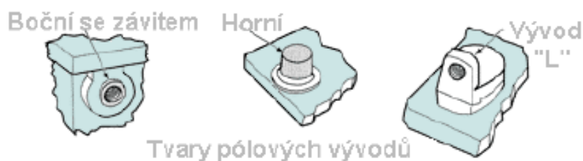
Obrázek 9 Tvary pólových vývodů akumulátoru.
