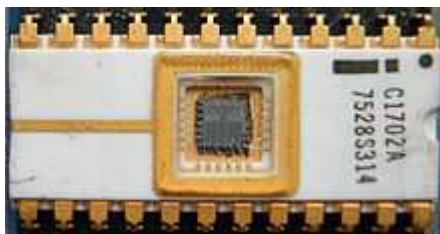
Obr. 6 EPROM. Malé okénko pod kterým je křemíkový čip slouží k mazání UV zářením
