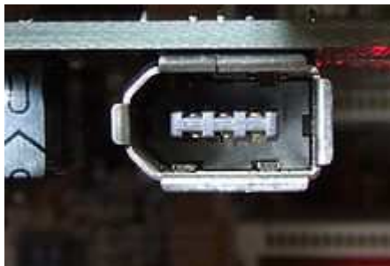
Obr. 11 Port FireWire 400 se šesti piny
