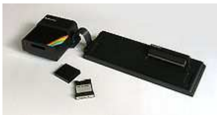
Obr. 32 ZX Interface I s připojenou mechanikou ZX Microdrive
