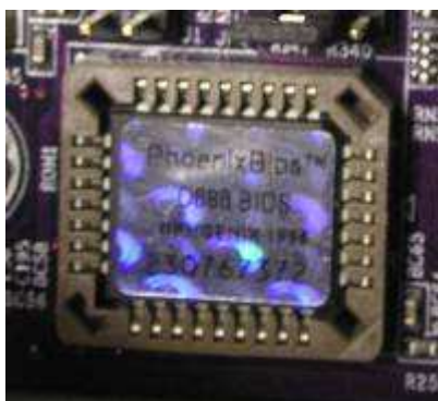
obr.21 Paměť typu FLASH s naprogramovaným BIOSem
