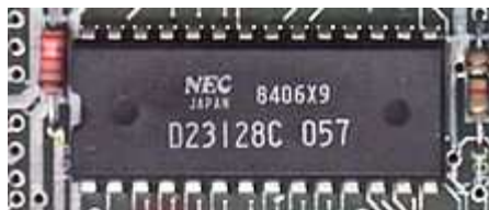
obr.20 Paměť PROM typu D23128C na desce počítače ZX Spectrum
