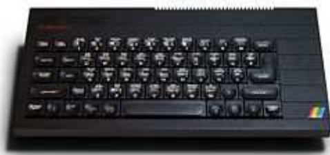
Obr. 24 ZX Spectrum+ (Rozměry (mm): 319 × 149 × 38 (ŠxHxV))
