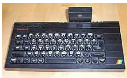
Obr. 25 ZX Spectrum+ se zapojeným rozhraním pro joystick
