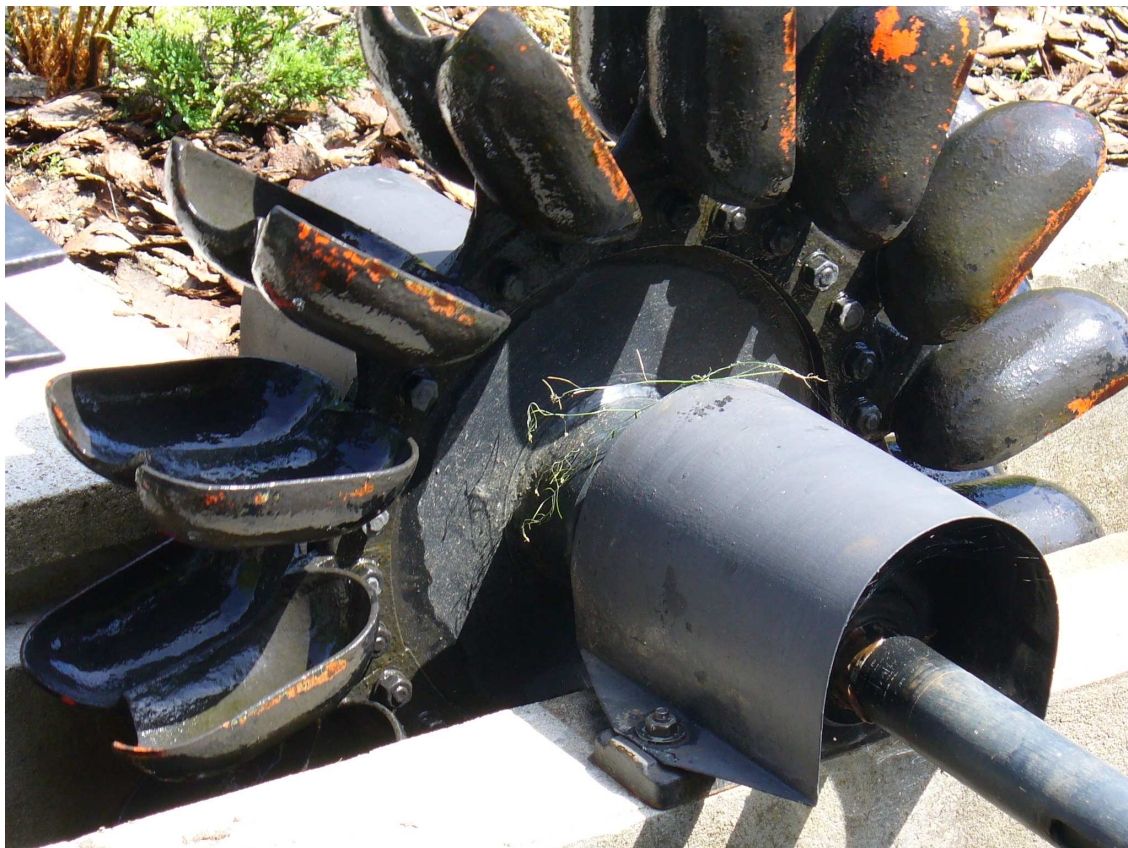
Obr. 7 Detailní pohled na lopatky Peltonovy turbíny
