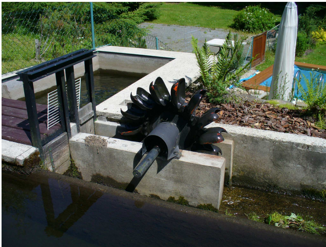
Obr. 1 Malá Peltonova turbína s typickými miskovitými lopatkami
