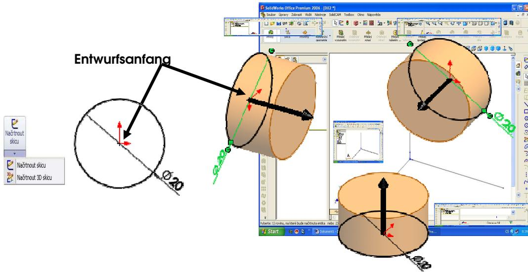
Entitäten kann man nur in der aktiven Ebene des Entwurfs zeichnen. Die aktive Entwurfsebene kann man nach den roten Pfeilen erkennen. Wenn der aktive Entwurf in der gewünschten Ebene geöffnet ist, kann man für Zeichnen einzelne Befehle per linken Mausklick wählen. (weiter nur LTM).
