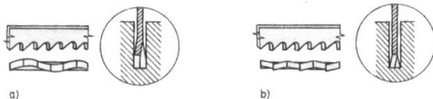
Obr. 19. Úprava zubů pilového listu a) zvlněním, b) rozvedením
