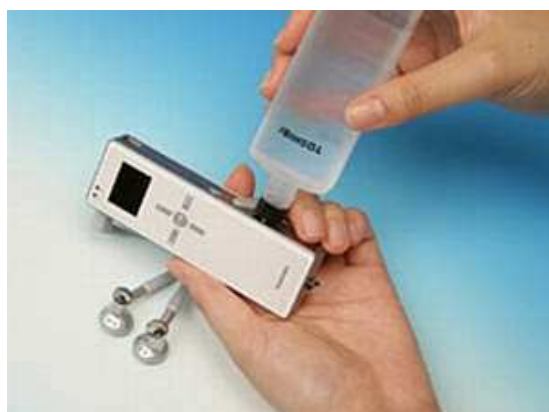
Obr. 8.31 Plnění metanolového palivového článku zabudovaného v MP3 přehrávači firmy Toshiba
