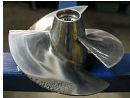
Lodní šroub poškozený kavitací.
