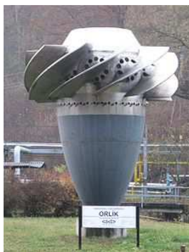
obr. 7.7 Kaplanova turbína, výrobek ČKD Blansko
