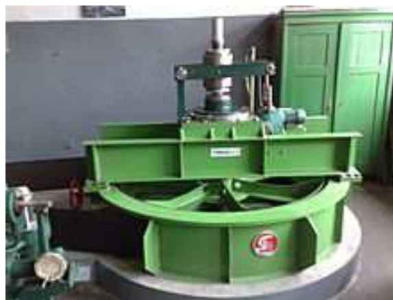
obr.7.8 Horní kryt Kaplanovy turbíny
