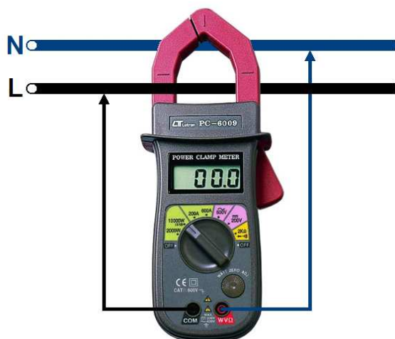
Obr. 5 Zapojení číslicového klešťového wattmetru
