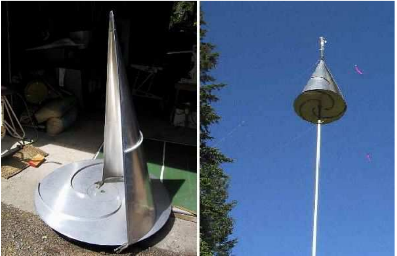
Kuželovitá větrná turbína. (Foto: Fundamentalform.com)
