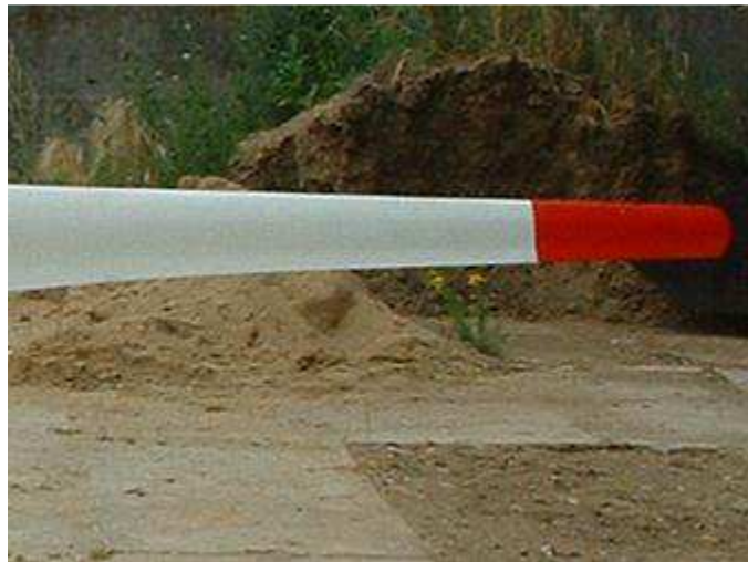
Obloukové zakončení rotorového listu u malé větrné elektrárny
