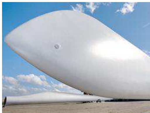
Zakončení rotorového listu do špičky. Na snímku je vidět i bleskosvod.
