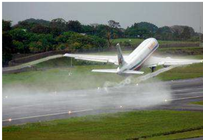
Dopravní letadlo startuje chvíli po dešti a díky tomu se krásně zviditelnil vír, který vzniká na konci křídla a způsobuje indukovaný odpor.
