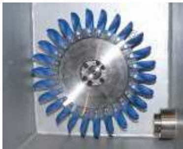
Kolo Peltonovy turbíny pro MVE. Foto EkoWATT
