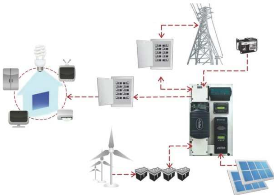
Obr. 3.22: Hybridní fotovoltaický systém [11]
