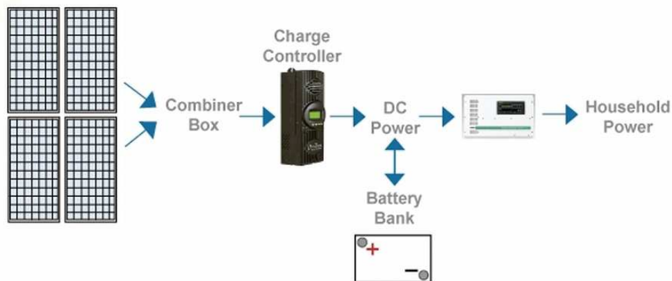
Obr. 3.21: Blokové schéma systému Grid-off [10]
